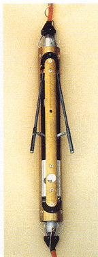
3. シャトル(正面) アームを開いた状態 本体下部に地震計が組み込まれている。
