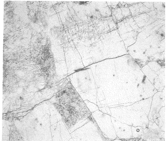
写真10 柘植鑄石の顕微鏡写真. 割目に褐鉄鉱が付着している. 左右 2\text{mm} (単=コル).
