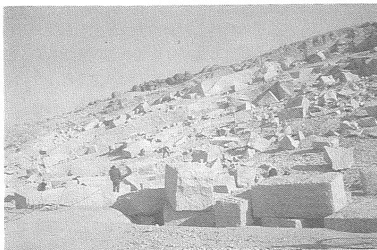
写真2 傾斜採掘法。中華人民共和国山東省五連 361採石場
