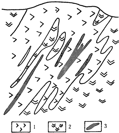
第33図 内蒙古自治区の一クロム鉄鉍鉱床の断面略図 (何越教ほか編著<中国的鉍産資源>1987) 1—橄欖岩 2—輝石橄欖岩 3—クロム鉄鉍鉱体
