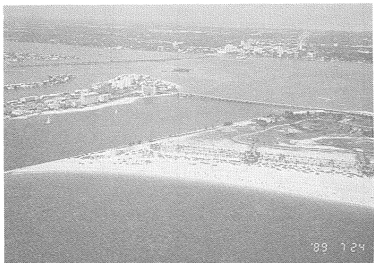
写真6 Sand Key 北端に設けられた突堤のため, 3年間で幅数100mにわたり砂が付加された. 左の潮流口は Clearwater Pass.
