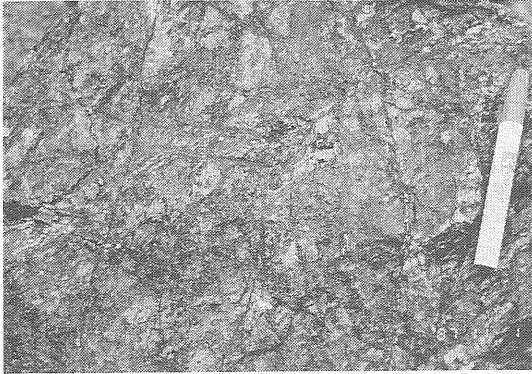
第15図 Picacho 鉱床 Dulcinea 鉱体の典型的な鉱化片麻岩の外観。よく発達した微細なクラック沿いに緑泥石化が著しい。
