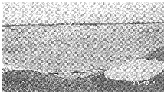
第6図 Mesquite 鉱山のヒーブリーチ後の貴液ポンド。運動会のような沢山の小旗は鳥除けのためのもの。
