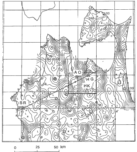
第2図 20万分の1重力図青森の概略と二次元構造解析用測線及びフィルタ適用範囲(等値線間隔: 5 mgal)。
