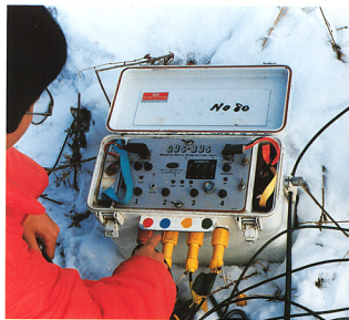
写真2 地震計の信号をA/D変換し、観測車へ送る装置。
