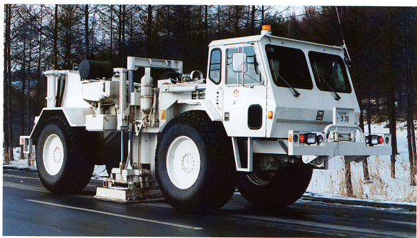
写真1 パイロサイスの全景。全長8.2m、全幅2.5m、全高3.3m、総重量17.5トン、表紙説明も参照。
