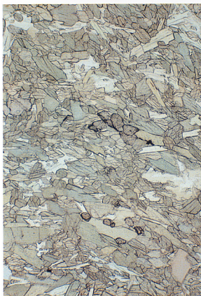
7. 鉾石の顕微鏡写真。上：角閃石-黒雲母-石英片岩；下：角閃岩。それぞれ、左：平行ニコル、右：十字ニコル。左側の写真で、レリーフの明瞭な屈折率の高い鉱物が灰重石。写真の左右0.5mm。
