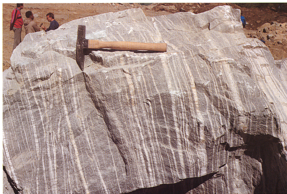
4. 東鉱体の灰重石鉱石、黒雲母-石英片岩、石英に富む白色部に灰重石が濃集。
