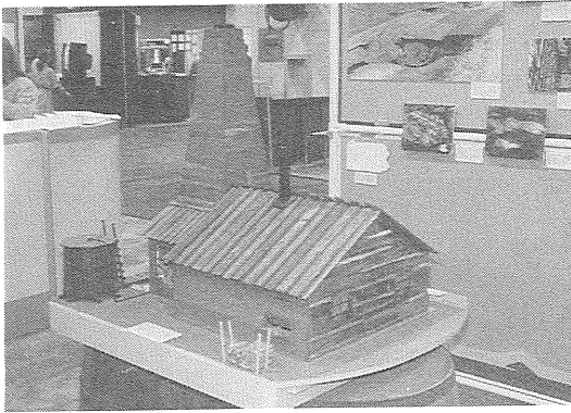
写真5 ペンシルヴァニア州地質調査所の展示。1859年 E. L. Drake が、パイプによるドリル式さく井法で世界最初に原油掘削に成功したときの坑井“ドレーク井”の模型が展示してあった。これからオイルラッシュが訪れることになる。
