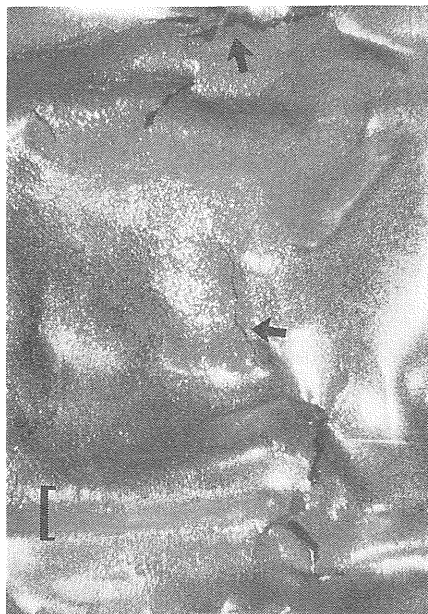
第4図 0.07mmの厚さのニッケル箔で作ったカプセルの失敗実験の例。スケールは長さ1mm。もともと鏡面のようにあったカプセルの内壁に ひび割れ(矢印)やポツポツができており ポロポロになっている様子が良く分かる。この問題はニッケル箔の厚さを変えたり 様々な工夫の結果解決することができた。
