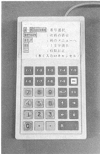
写真2 テンキーやファンクションキーなど29個からなるキーボード (日本テクニカル工業製 ENTRY-1)
