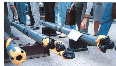
↑口絵3 資料採取用ダイヤモンドビット(左)と3つのコーンをずらして坑井内に落下させ(中央) 孔底で組み合わせて掘削する(右) 特殊なビット。(ソ連 本文P. 8 参照)。
