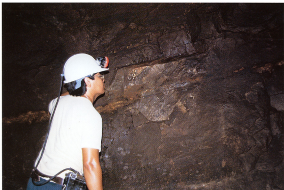
↑写真4 エンペラー鉱山の坑内。エンペラーシャッター鉱体に見られる緩傾斜の粘土脈（人物の肩の所）、彼らはこれをフラットマークと呼んでおり 主要な金鉱石の1つである。
