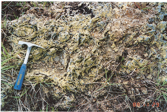
↑写真7 ブンダ探鉱地の石英・明ばん石帯のクローズアップ。母岩は安山岩質角礫岩で この中の金品位は低い。
