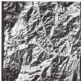
↑写真7 陰影図による実体視。通常の空中写真を実体視しているかのように見える。
