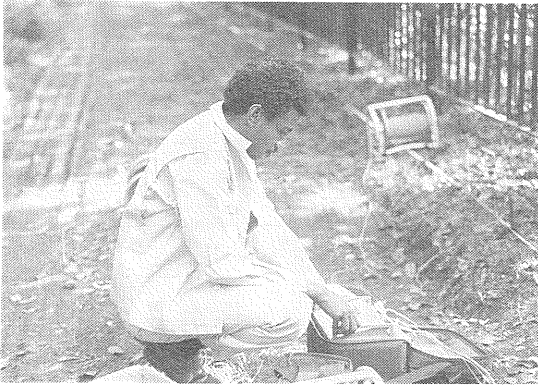
写真1 実習風景。電気探査装置を操作しているところ。測線を道路沿いにとったところ 測線がフェンスに近すぎて測定値に影響が出たため 測線を道路の反対側に移した。
