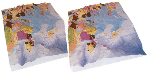
C. 関東地方の地質のステレオ鳥瞰図。地質調査所100万分の1地質図の数値ファイルから作成した。上越の山なみが奥行きをもって眺められる。
