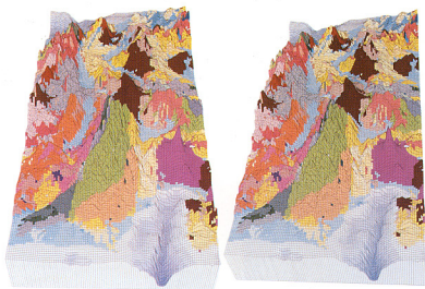
C. 関東地方の地質のステレオ鳥瞰図。地質調査所100万分の1地質図の数値ファイルから作成した。上越の山なみが奥行きをもって眺められる。
