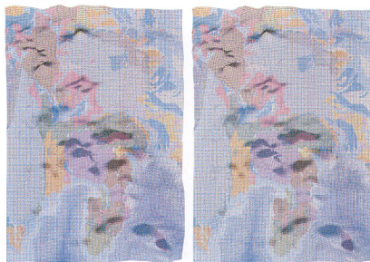
I. 空中磁気異常の起伏をもつ南部フォッサマグナ地域の地質図。空中磁気異常をステレオに表わした曲面に地質図を表現した。立体視を容易にするために 陰影をつけている。
