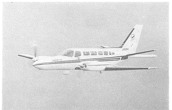
第10図 磁気探査用航空機（セスナ404型）。 磁場センサーは機体磁気の影響を避けるため尾部突起（スティンガーと呼ぶ）の先端近くに設置される。
