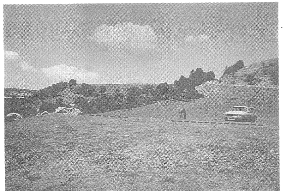
第16図 トルコ西部イェニジェ付近の1944年地震断層(破線)におけるαトラック測定。
