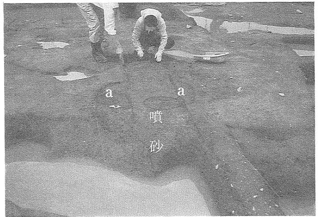
写真-4 土塚墓(a)を引き裂く噴砂
