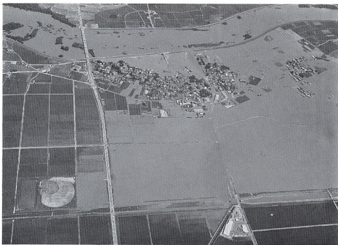
写真-15 13時頃 堤防決壊約3時間後の浸水状況。正面本豊田集落を一飲みにした浸水流は下流の水海道市（写真右）方向へどんどん拡大していきます。浸水流が流れ込んだ手前南北（左右）に流れる八間堀川は下流側の各所で二次氾濫をして被害をさらに大きくしました（写真提供 第一航業株式会社）。
