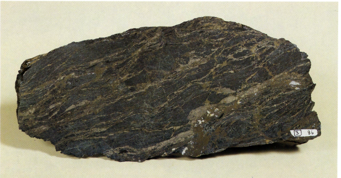
写真7 同上縞状鉱、坑内L18 N6 地点(新鉱体)、灰緑色の部分は緑泥石化した粘板岩、鉱石部分は黄銅鉱 磁硫鉄鉱 コバルトペントランド鉱からなる。品位はCu 3% Co 0.17%と推定される。(横幅25cm)(写真6.7撮影:矢島淳吉)
