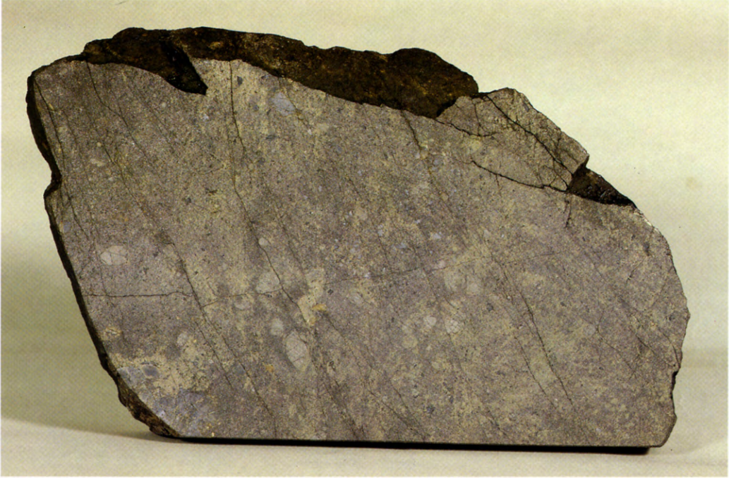
写真6 含銅コバルト塊状硫化物鉱石、北海道上川郡下川町下川鉱山産、緻密塊状鉱石、坑内L13 S16 地点(17号鉱体)。鉱石の中に散点する破砕片は自形黄鉄鉱の集合体で、基質は磁硫鉄鉱(コバルトペントランド鉱を含む)黄銅鉱(マツキナウ鉱を含む)閃亜鉛鉱等からなる。品位はCu 15% Co 0.5%と推定される。(横幅20cm)
