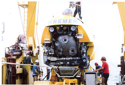
→ 写真2 正面から見たノチール。3つの観察窓 2本のマニピレータ スチルカメラ等が見える。
