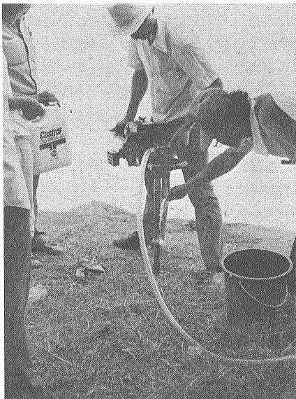
写真3 エンジン付オーガーによる岩石試料の採取。タイ、ソクラ付近。
