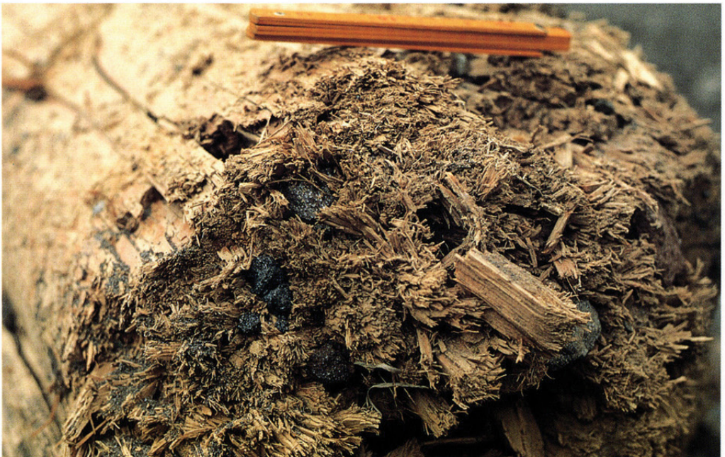
写真4 写真3の折れた樹幹の断面をクローズアップしたもの。様々な岩片が弾丸のように打ち込まれている。したたかに食い込んだ岩片の中にはハンマーで打ったように砕かれたものも見られる。スケールの位置は写真3と同じ。
