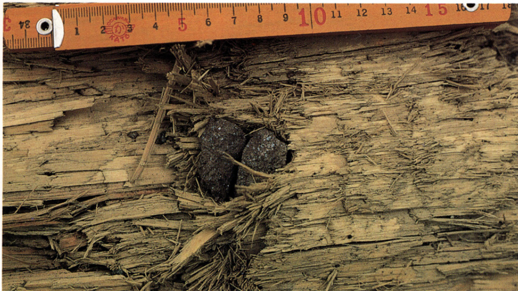
写真5 写真3の樹幹の側面に打ち込まれ砕かれた岩片。木の筋の曲がり具合から岩片が写真の向かって左方から斜めに打ち込まれていることが分かる。周囲には0.5～2mmの砂粒も樹幹に食い込んでいる。
