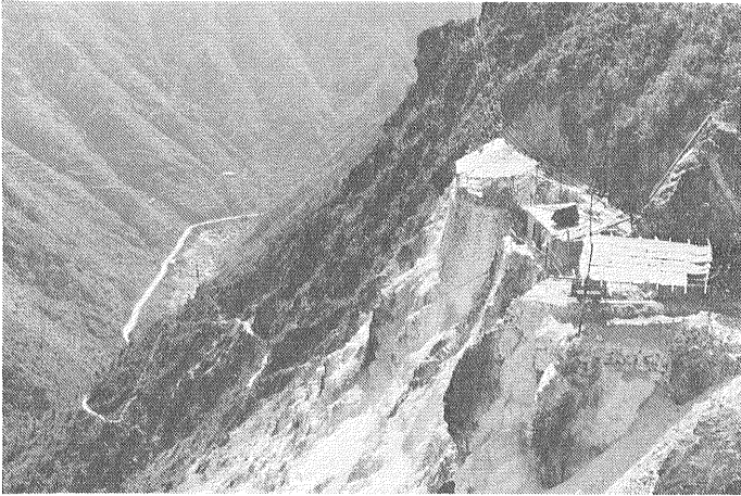
写真2 中国浙江省青田県山口村の奉門ろう石鉱山選鉱場。高さ数100mの断崖の中腹に坑道が設けられ 選別された鉱石は索道で出荷される。(ITIT 事業—耐火物原料資源の研究)
