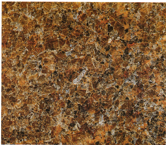
写真1 茶色のカリ長石(微斜長石)に富む黒雲母花こう岩、弱い閃光を発する、実物の約1.3倍 “マホガニー”(USA)
