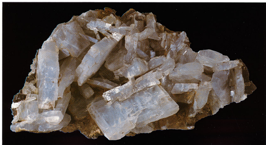
写真7 北海道特山鉱山産 重晶石(BaSO 4 斜方晶系)(GSJ M 16716) 浅熱水性網状脈鉱床の主成分として産する。淡青色板状結晶をなす。(×2/3)。
