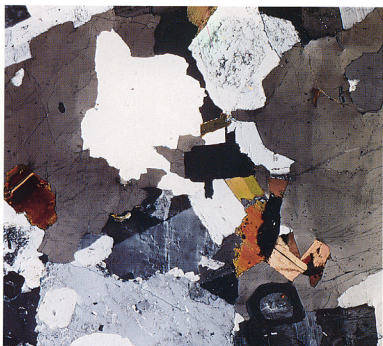
〈1〉 中粒黒雲母花崗岩 ×16 [R26406] 茨城県笠間市稲田 高田石材採岩倉下場。 (稲田花崗岩)
