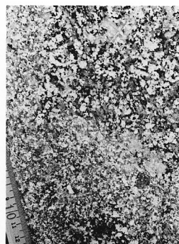
写真10 斑状黒雲母花崗岩と混在中粒黒雲母花崗岩 下坑口から 430m (GSJR-70008)
