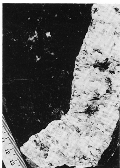
写真7 泥質変成岩を貫くペグマタイト 上坑口から 650m (GSJR-70010)
