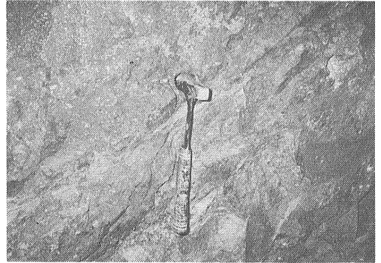
写真10 火山礫を含むレンズ状塊状鉱石. 490mレベル No.8坑道. 鉱体の中央部付近.
