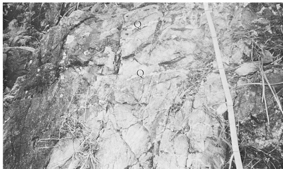
写真4 新鉱床露頭部（海拔900m付近）における白雲母—石英細脈（Q）。この様な細脈を手懸りに、花崗岩から離れた堆積岩地域の鉱脈探査は実施される。
