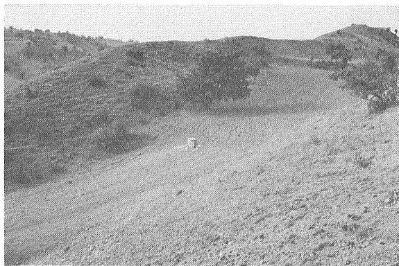
第30図 (1944年の地震断層跡に設置されたMTAのクリープメーター。第29図と同じ場所)
