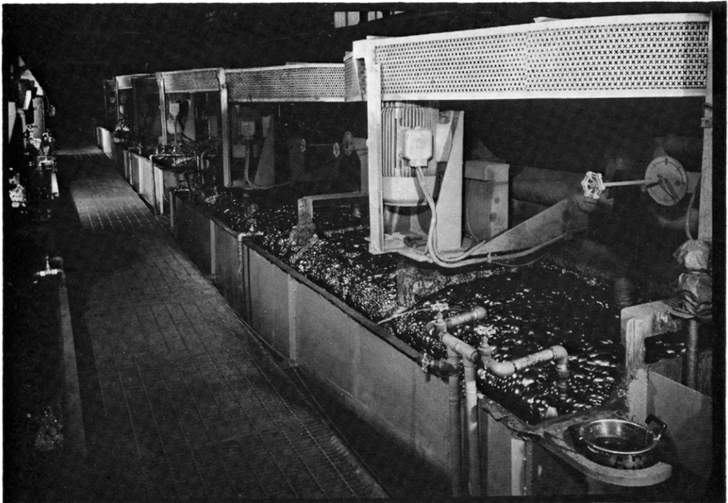
写真4 浮遊選鉱場 坑内から運び出された鉱石は 選鉱場で数段階で破碎され 更に粉末状にされた後に 浮遊選鉱に供される。 ここでは 水に特殊な薬品を添加して泡を発生させ 微粉状の金属鉱物を泡の表面に附着させて岩石粉から分 離するとともに 銅 鉛 亜鉛などそれぞれを分離する作業が行われている。 回収された金属分から物理的 に水分を除去したものは精鉱と呼ばれ 製錬の元鉱となる。
