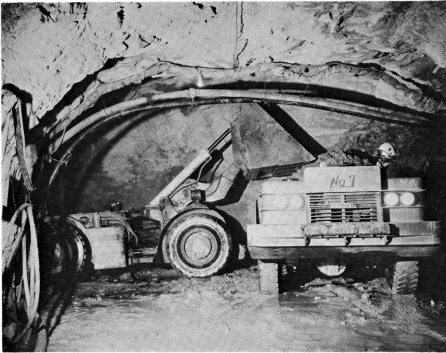
写真3 ローダーと運搬車 発破で崩された大量の 岩石や鉱石はローダー (左)で運搬車(右)に積 込まれて坑外へ運ばれ る(表紙の写真も参照) 昔と違って すべて機 械化され トロッキも レールも坑内にはない。 坑道で見える部分はほ とんど鉛・亜鉛鉱石で ある。
