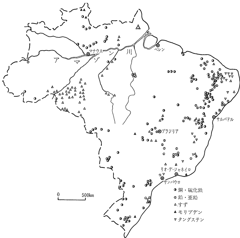
第3図 ブラジルの鉱床分布図(クロム, ニオブ・タンタル, ウラン) (MAPA METALOGENTICO DO BRASIL より作成)
