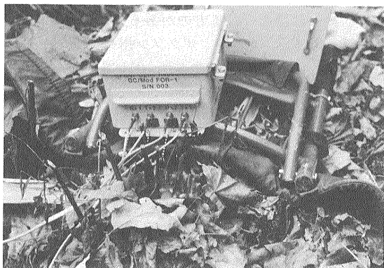
第13図 MT法でも光ファイバーが従来の電線にかわって使用されている。
