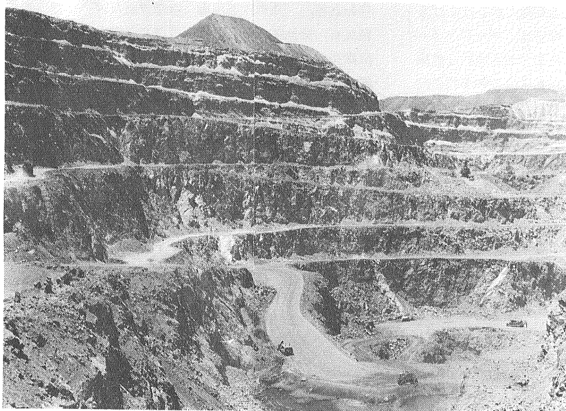
写真10 セロ・イマン鉄鉱床における露天掘り。ピットはかなり急傾斜である。 (コピアボ北西方 1979年11月)。
