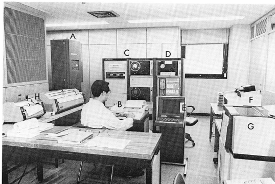
写真7 テレメータ室。A: 親局 (各観測データを2分ごとに受信) B: コンピューター C: データ集積装置 D: 気象庁への送信装置 (地質調査所経由で送信) E: グラフィックディスプレイ F: ハードコピー G: ラインプリンター H: XYプロッター
