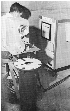
写真4 水位自動観測装置
