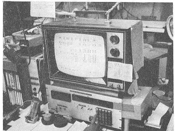
第20図 白嶺丸第1研究室内での使用例 中央下がエアガン モニタのコンソール 中央上がモニタテレビ 右端がプリンタ
