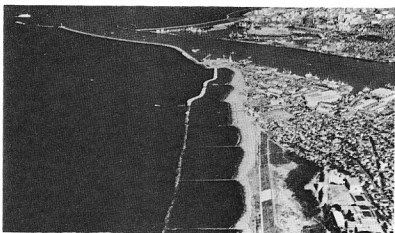
写真3 土砂の急激な減少に伴う侵食から 突堤 と離岸堤などによって守られた新潟市西 海岸の現況 (1974年10月撮影)
