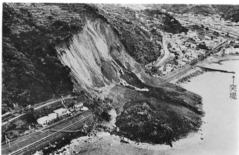
写真4 豪雨に伴う斜面の 崩壊と“陸地”の 形成 1976年7 月12日静岡県東伊 豆町白田 (毎日新聞社提供 写真名「海岸沿いの家をひとのみ」)
