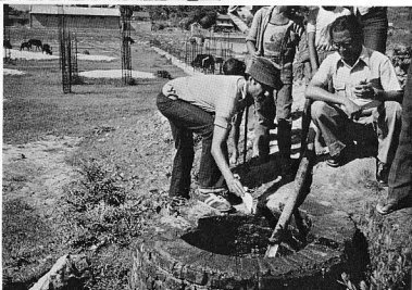
写真8 自噴井の坑口に点火テスト 中の鉱山地質局 Mr. G. S. THAPA (左) および Mr. P. R. STHAPIT
