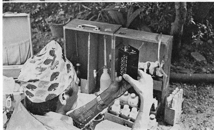
写真5 分析用ガス試料を 採集中のネパール 鉱山地質局 Mr. S. K. GIRI および指導中の本 島技官
