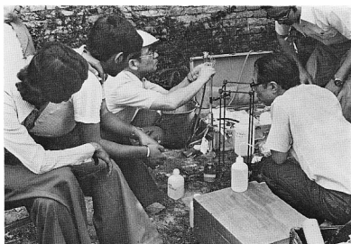
写真7 付随水中の溶存ガスを 分析する永田技官
