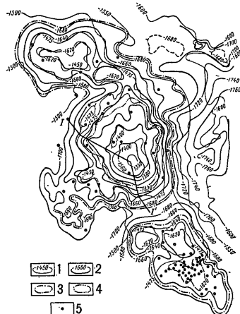
第21図 アプト階産油層のルーフによるジュネヴァルトフスク地帯中央部の構造形態 1—M反射層の等深度線(m) 2—産油層ルーフの等深度線(m) 3—石油胚胎鉞面 4—天然ガス胚胎鉞面 5—試錐点
