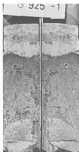
図22 半載のサブコア(測点1458 G 925) 全長32cm スミヤスライド観察によれば最上部4cmが珪質粘土でその他は含フッ石
