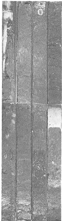
図51 ピストンコア（測点1481A-2 P138）各コアの長さ1m 左から右に順次上位から下位のコアがならんでいる。3.5m付近にある白色の層はナノ軟泥タービダイト（中新世初期）
