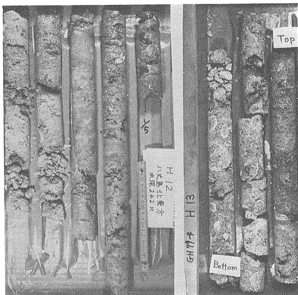
写真13 八丈島北方の海台から海底試錐機で得た岩石コア 左は砂質石灰岩 右は石灰藻石灰岩
