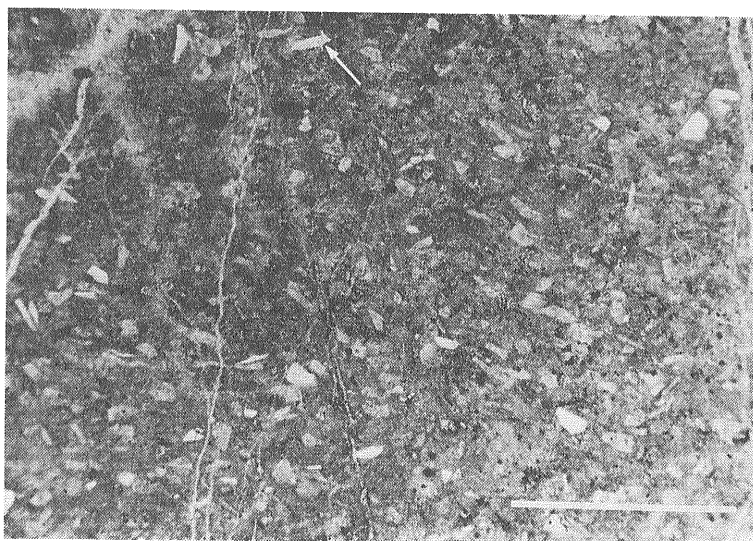
写真17 多数の自生石英 (たとえば矢印) が含まれる おそらく海綿骨針岩 (spicularite) とと思われる資 料 (UHA 3-2 船戸林道) の透過光顕微鏡写真 スケール (白線) は 1mm
