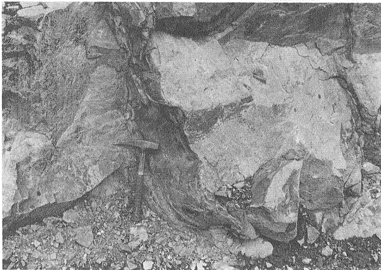
写真11 厚砂岩層下底のロードキャスト 大規模林道
