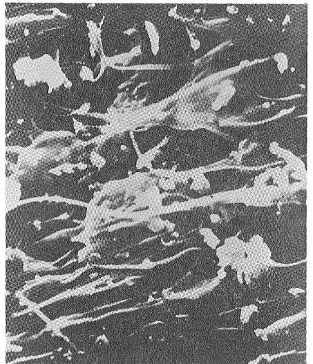
図9 砂岩の摩擦実験で生じたガラス繊維の走査型電子顕微鏡写真 (FRIEDMAN 1974)。
