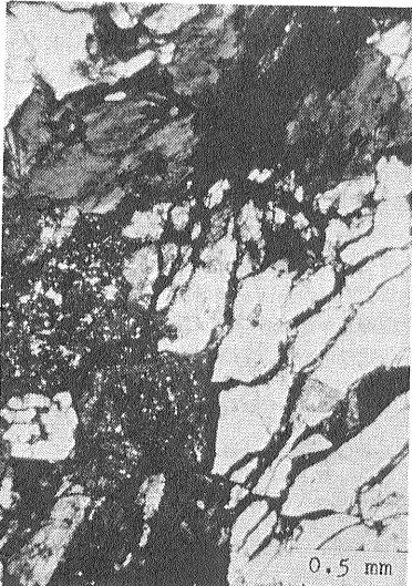
風化花崗岩薄片の顕微鏡写真 鉱物結晶間の分離はもとより 鉱物自身も分解・破壊されている 気泡・くもりなど十分に除去され 奇麗に仕上がっている
