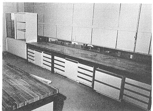
図 16 実験台に取付ける収納ユニットの仕様図と完成したものの実験台の寸法に応じていくつかの組合せが可能である
