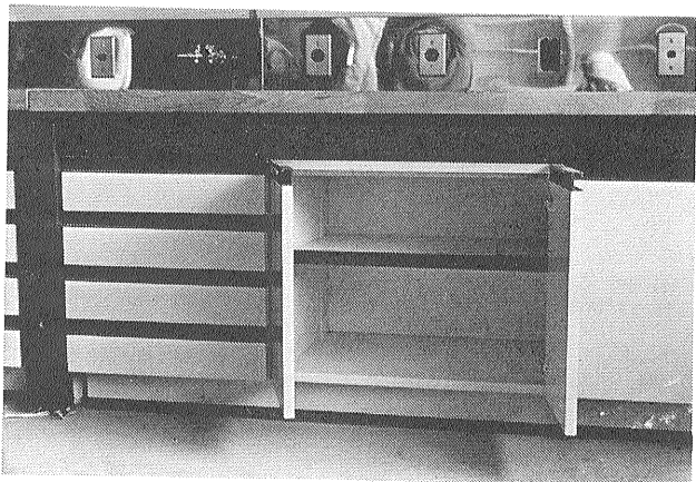
図 17 収納ユニットを組込んだ片面実験台と床置型収納棚 サービスストリップと組合わせてセットされた片面実験台 奥のガラスの戸棚が収納棚である 物理系標準実験室の室内装備の典型的な例である
