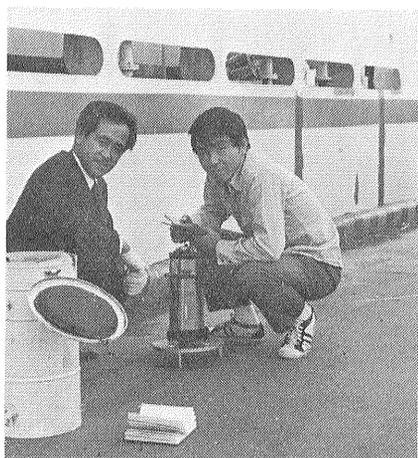
図2 テキサス・インスツルメント社製ウォルドン重力計モデルIII No. 699. 後は白嶺丸である
