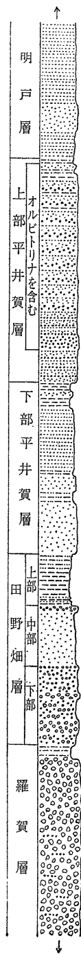
第4図 平井賀北岸の宮古層群層序柱状図 1 砂質シルト岩 2 細砂質シルト岩～シルト質細粒砂岩 3 砂質シルト岩砂岩薄互層 4 細粒砂岩 5 中粒砂岩 6 粗粒砂岩 7 礫岩
