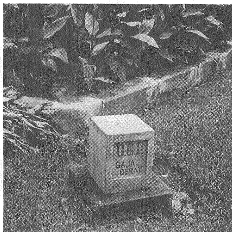
② インドネシア地質調査所構内にある重力の基準点
